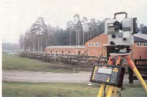
Abb. 4: Vermessung im Gehegebereich: Elektronischer Tachymeter mit Feldcomputer vor dem Giraffenhaus.
